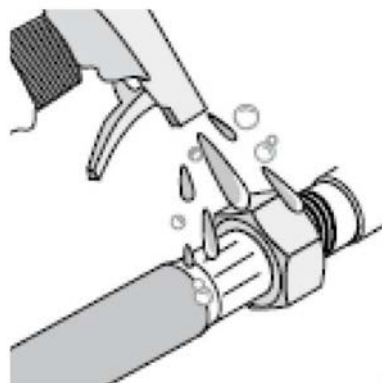
Test alle aansluitingen op gaslekken met een zeepoplossing.
